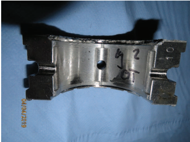
Radial-Axiallager Nr.2 Oberteil Befund: Komplette Axialseite abgeschliffen
