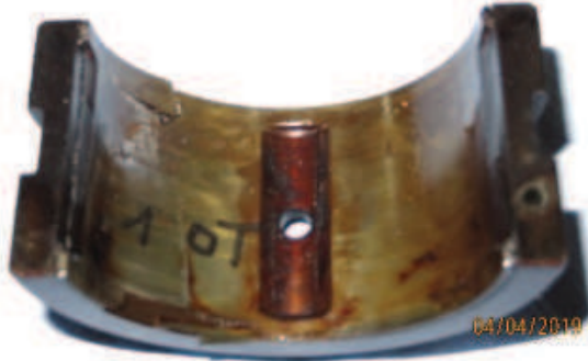
Radiallager Nr.1 Oberteil Befund: Bindungsanzeigen und Ausbrüche im Weißmetall
