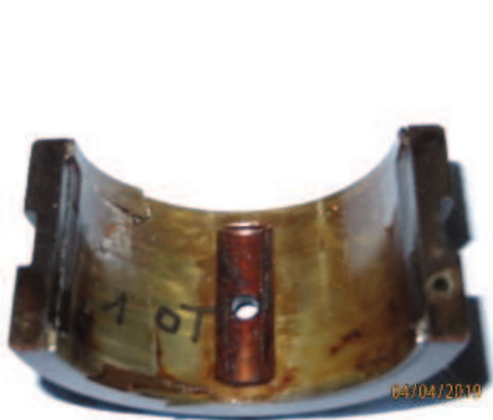
Radiallager Nr.1 Oberteil Befund: Bindungsanzeigen und Ausbrüche im Weißmetall
