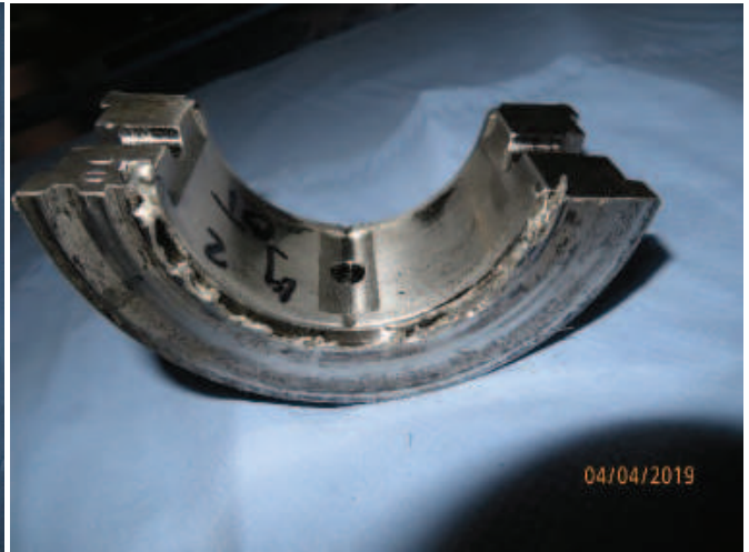
Radial-Axiallager Nr.2 Oberteil Befund: Komplette Axialseite abgeschliffen
