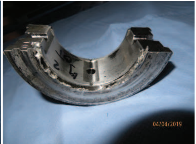
Radial-Axiallager Nr.2 Oberteil Befund: Komplette Axialseite abgeschliffen
