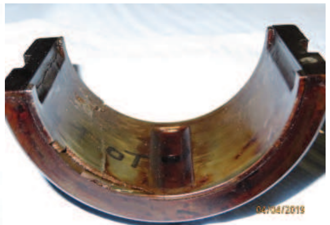
Radiallager Nr.1 Oberteil Befund: Bindungsanzeigen und Ausbrüche im Weißmetall
